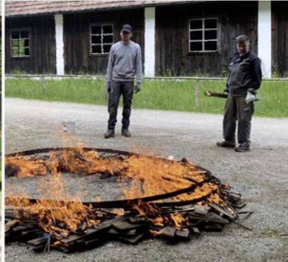
Zwei heiße Eisenreifen müssen auf das neu gezimmerte Wasserrad aufgezogen werden, bevor es seine kraftvolle Arbeit an der Mühle leisten kann.
